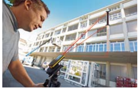
Epäsuora korkeudenmittaus: Ikkunoiden korkeudet voidaan määrittää käyttämällä Pythagoraan funktiota.
