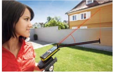
Määrittää vaakasuoran etäisyyden esteistä huolimatta. Kallistusanturi tekee sen mahdolliseksi.
